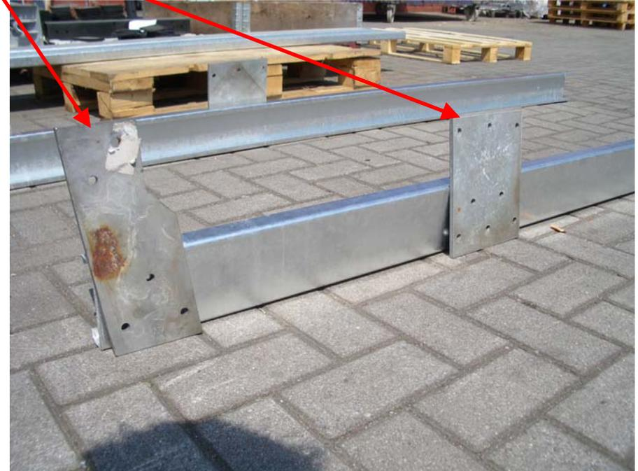
Alle vorhanden Bohrungen an den Platten müssen mit dem Chassis bzw. mit den Längsträgern verschraubt werden.
