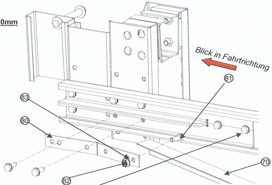
**Hinweis:** Wenn keine Bohrung und oder Hülsen vorhanden sind, Bohrung einbringen und /oder aufbohren auf Hüsendurchmesser von der Fahrzeugaußenseite. Korrosionsschutz auftragen.
