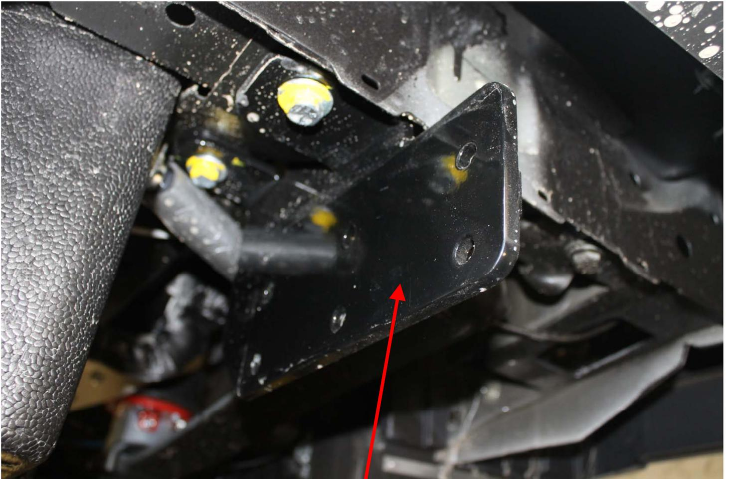
Längsträger demontieren, sodass nur noch der Rahmenadapter über bleibt
