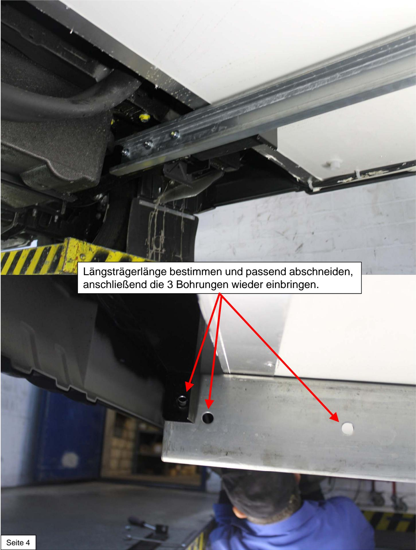
Längsträgerlänge bestimmen und passend abschneiden, anschließend die 3 Bohrungen wieder einbringen.
