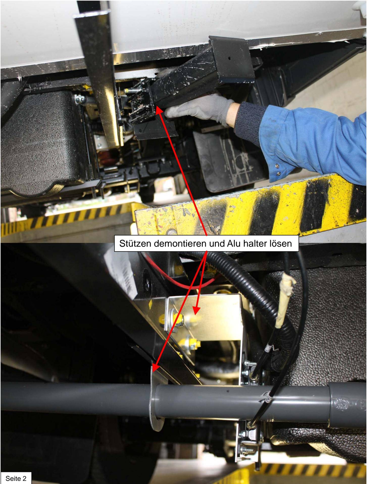
Stützen demontieren und Alu halter lösen
