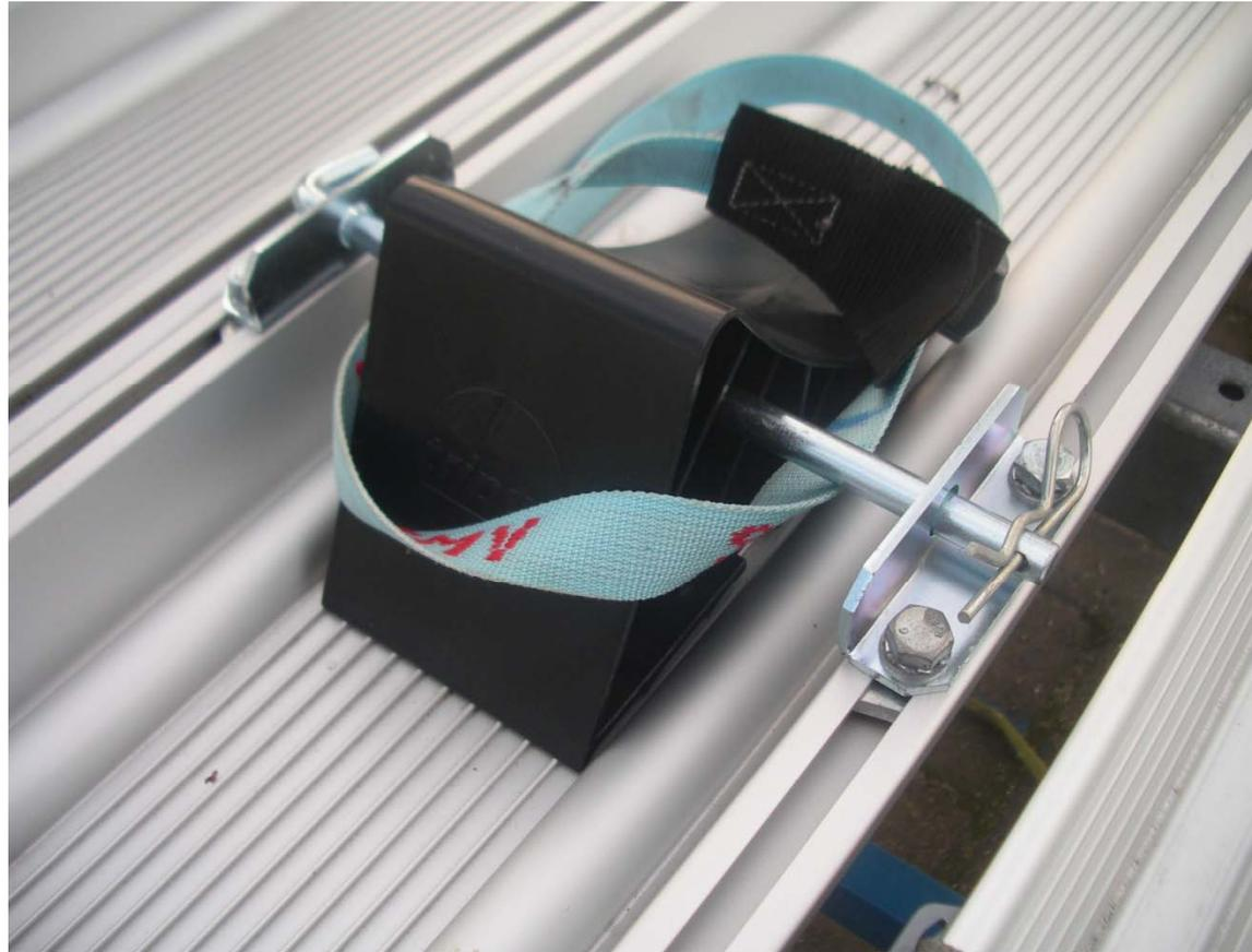
Sichern sie ihr zu transportierendes Fahrzeug immer mit den Spanngurten am Keil wie auf dem Foto. Dabei führen sie den Spanngurt durch die Felge.
