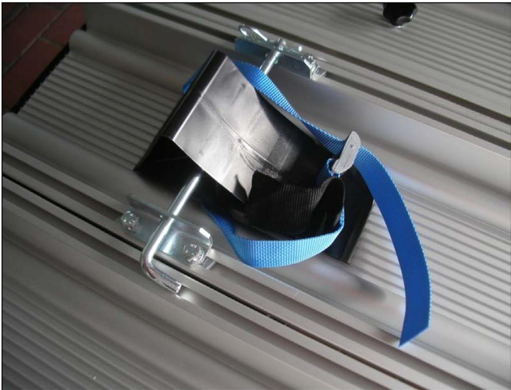
Zur Sicherung des Rollis gegen das Wegrollen beim Abstellen, sind diese Keile zu verwenden!!! Diese können problemlos vor die Räder des Rollis platziert werden.
